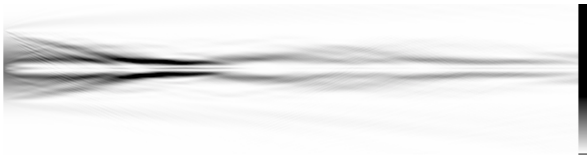
Figure III-1.17 : simulation de la propagation sur 100 \mu\text{m} dans une structure à quatre quaternaires et cœur absorbant de 1 \mu\text{m} . On voit très bien l'effet de lentille qui focalise la lumière vers le cœur absorbant.
